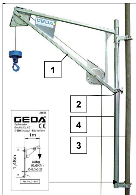
Rys. 12 Uchwyt ramienia obrotowego MINI 60 S
